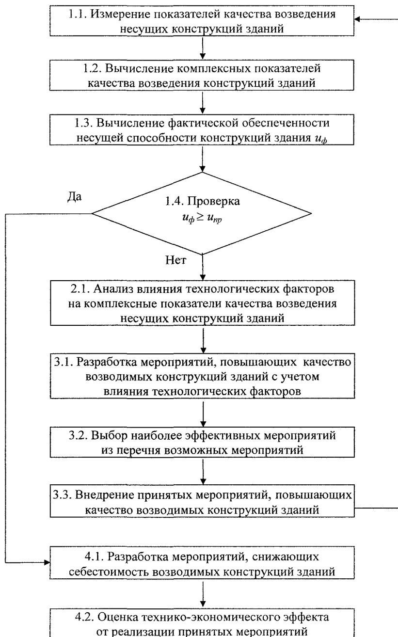
Блок-схема алгоритма оценки качества и принятия решений по обеспечению качества возводимых конструкций гражданских зданий
