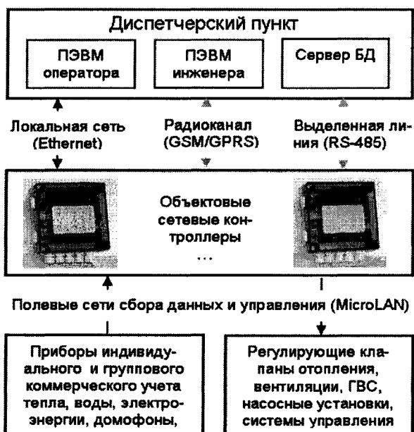
Рис. 1. Структура АСДУ теплоснабжением зданий
