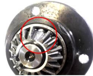
Рис. 17. Шестерня со сломанным зубом
