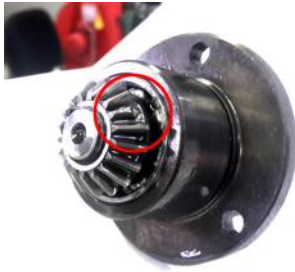
Рис. 16. Шестерня со сколотым зубом
