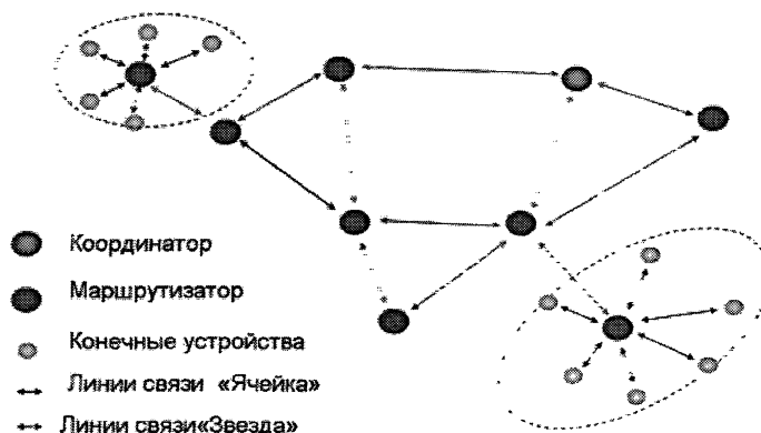
Рис. 2. Топологии сети ZigBee
