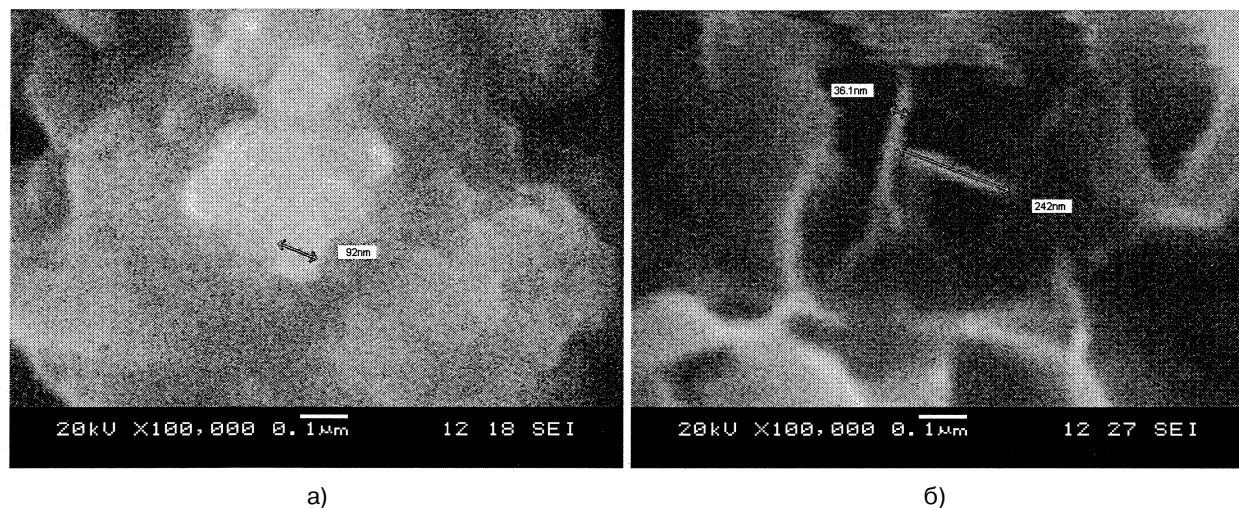
Рис. 4. Электронные микрофотографии максимально сорбирующих оксигидрата циркония (а) и оксигидрата иттрия (б)
