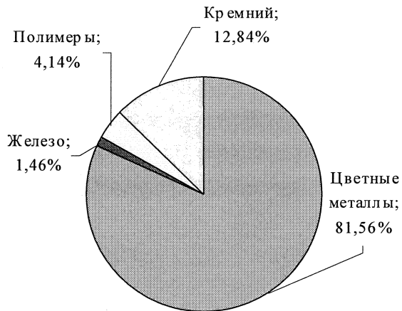
Рис. 3. Общая структура экономической ценности отходов потребления электронной техники с учетом краткосрочного тренда цен
