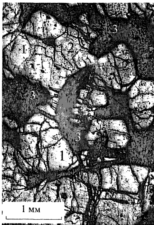
Рис. 1. Первичный тип структуры хромовой руды Волчьегогорского месторождения. 1 - хромшпинелид первичный; 2 - хромшпинелид метаморфогенный; 3 - хлорит. Отраженный свет
