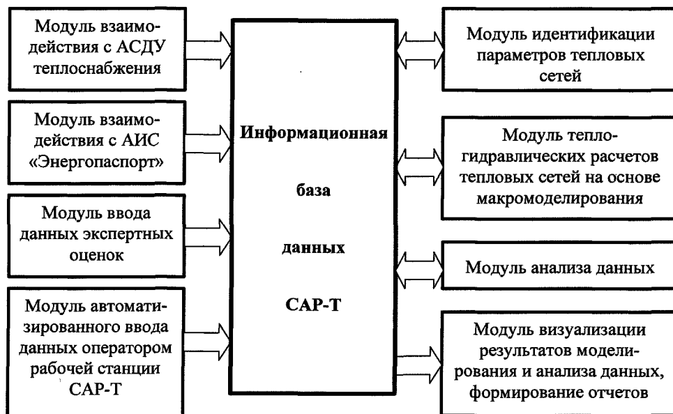
Рис. 3. Структура программного обеспечения SCADA-T
