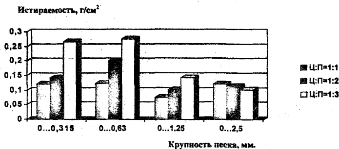
Рис. 3. Истираемость магнезиального раствора по ГОСТ 10180-78 в зависимости от цементно-песчаного отношения и крупности применяемого заполнителя
