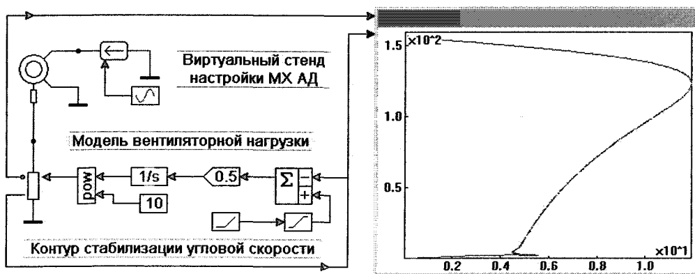
Рис. 4. Пример построения модели из условных графических обозначений физических устройств и математических блоков
