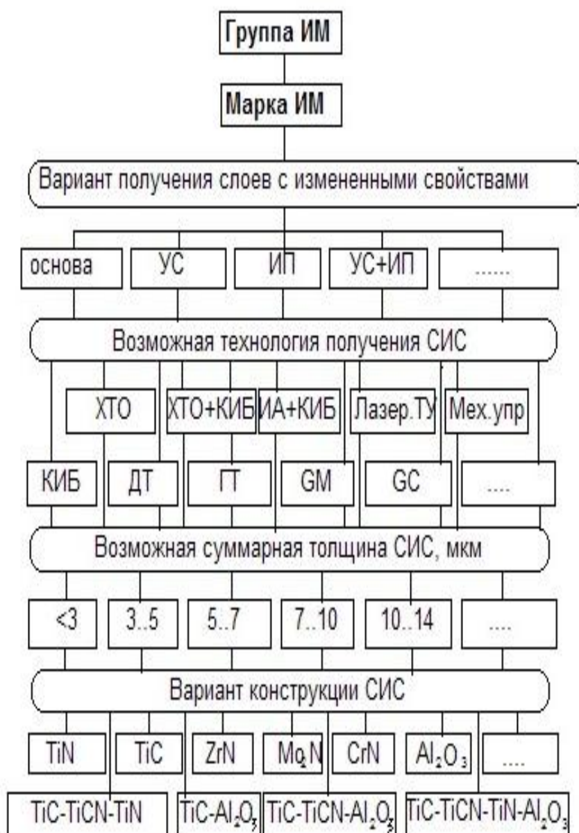
Систематизация вариантов материала режущей части инструментов, имеющих слои с измененными свойствами для их альтернативного выбора при проектировании процессов резания
