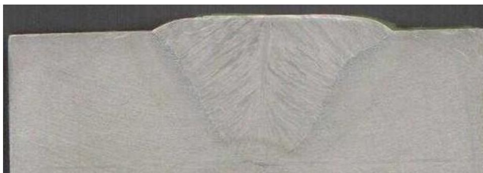
Рис. 3. Микрошлиф сварного соединения образца, выполненного четырехдуговой сваркой
