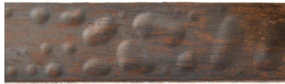
Рис. 1. Пузыри на поверхности биметалла
