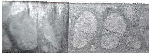
Рис. 2. Строение поверхности биметалла после отделения плакирующей латуни (левая часть фото – латунь Л90, правая – АмГ2). Отжиг при температуре в зоне выдержки 550 °С, время выдержки 360 секунд
