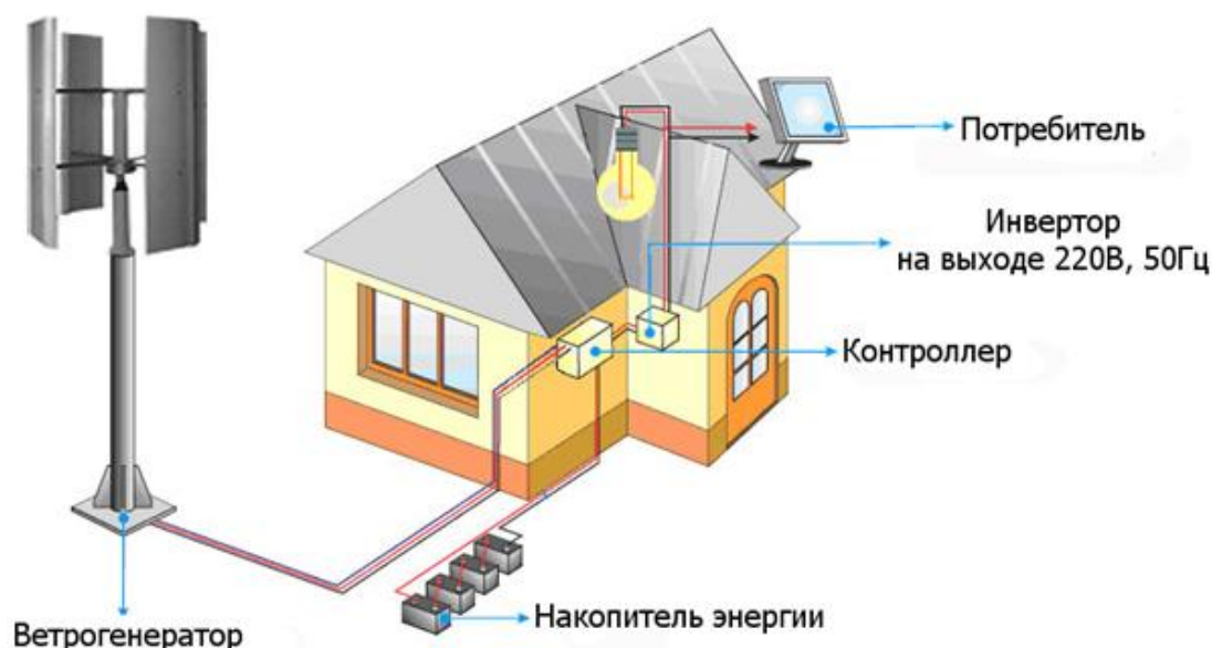
Рис. 1. Схема автономной энергосистемы
