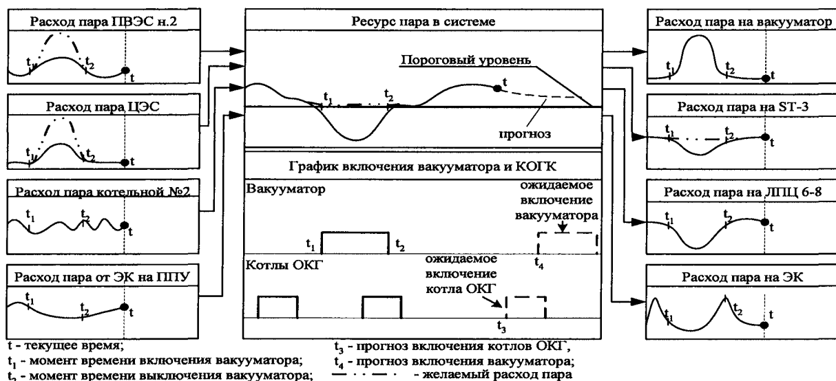
Рис. 5. Пример экранной формы АРМ диспетчеров пароснабжения промплощадки
