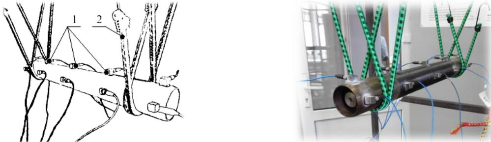
Рис. 4. Экспериментальная установка: 1 – однокомпонентные акселерометры (10шт.); 2 – податливые тросы (4 шт.)
