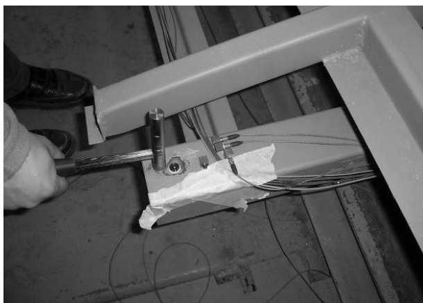
Рис. 3. Возбуждение колебаний каркаса крыши с использованием ударного молотка
