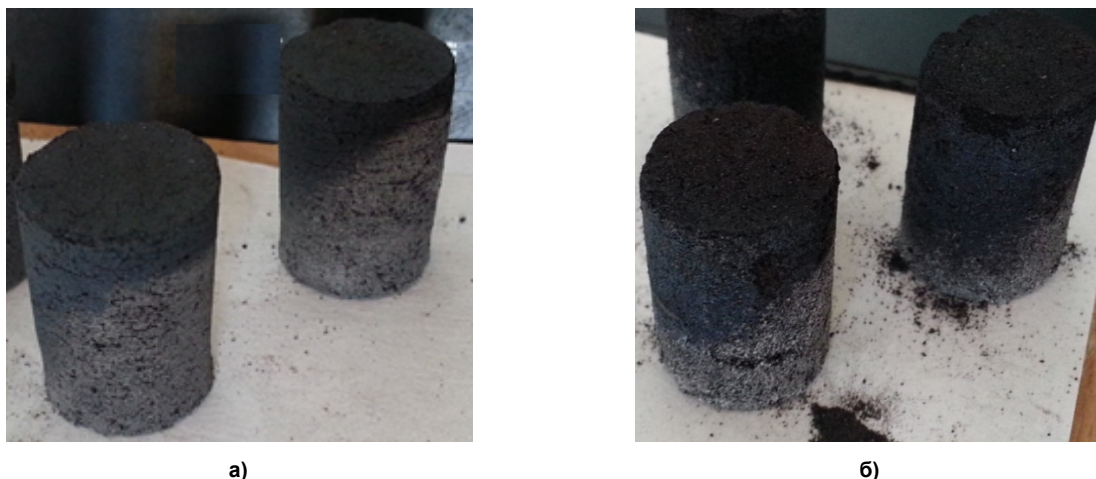
Рис. 1. Внешний вид после обжига брикетов с содержанием руды фракции ≤ 71 мкм: а – 80 %, б – 40%
