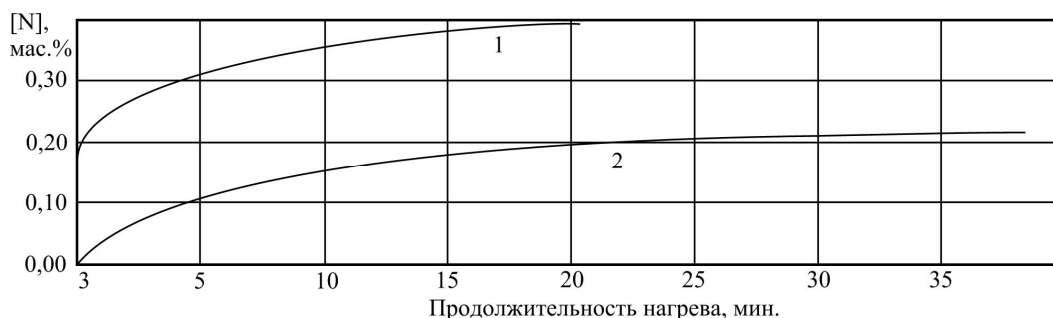
Рис. 2. Содержание азота в металлическом хроме в зависимости от продолжительности нагрева. Нагрев при T = 850 °C. Исходное содержание азота: 1 – 0,165 мас. %; 2 – 0,030 мас. %
