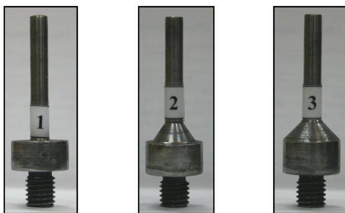
Рис. 2. Фотографические изображения пресс-игл (маркировка пресс-игл соответствует их порядковой нумерации)
