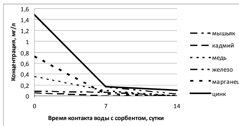
Рис. 1. Зависимость концентрации тяжёлых металлов в воде реки Серебрянки (проба 1) от времени контакта с композиционным сорбентом
