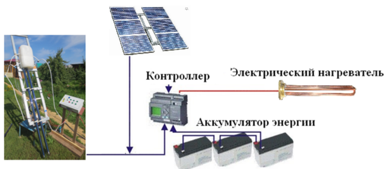
Рис. 3. Схема использования солнечных батарей в солнечной опреснительной установке
