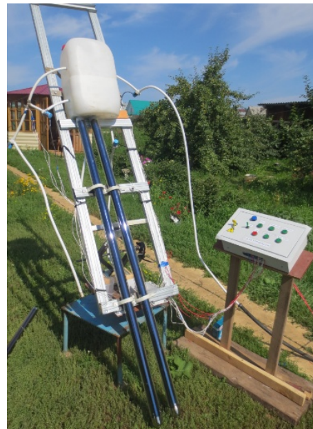
Рис. 1. Общий вид солнечной опреснительной установки: 1 – солнечная батарея; 2 – устройство слежения за солнцем; 3 – электромагнитный клапан; 4 – солнечные коллекторы
