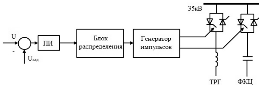
Рис. 4. Функциональная схема управления СТК
