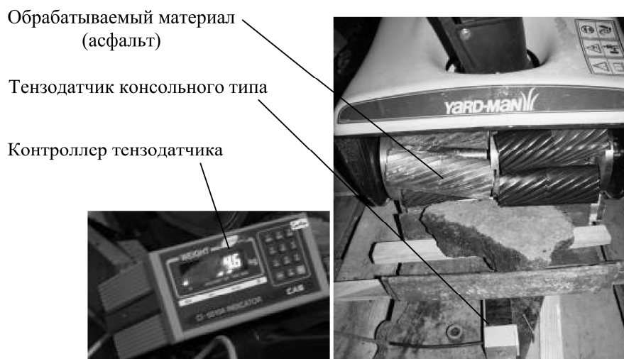
Рис. 2. Фото стенда для измерения вертикальной составляющей силы резания в ручном режиме работы агрегата
