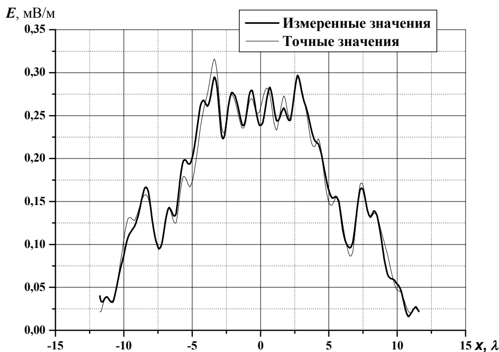
Рис. 1. Амплитудные распределения на линии измерений
