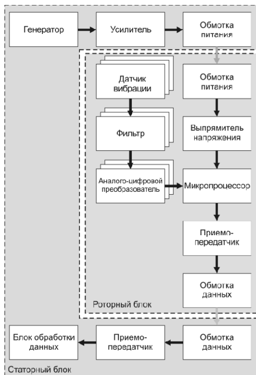
Рис. 2. Блок-схема работы устройства измерения виброускорения подвижных элементов машин и механизмов
