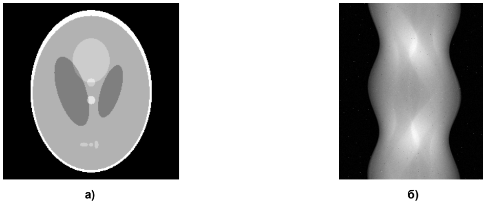
Рис. 1. Фантом Шеппа–Логана: а – исходное изображение; б – зашумлённые проекционные данные
