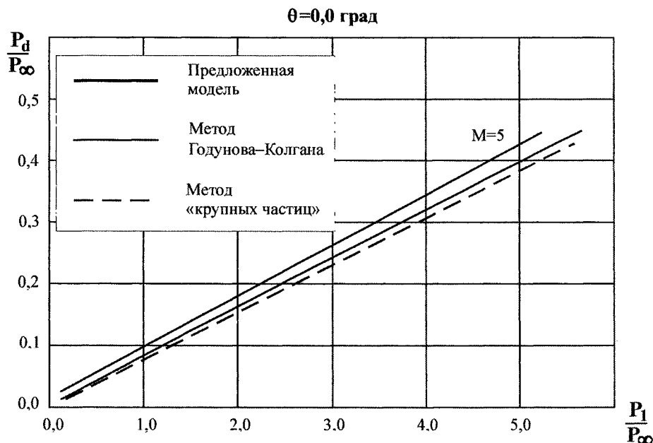
Рис. 9. Результаты расчета зависимости величины донного давления от давления в точке отрыва потока различными методами
