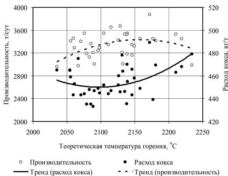
Рис. 1. Взаимосвязь производительности и удельного расхода кокса с теоретической температурой горения в фурменных очагах
