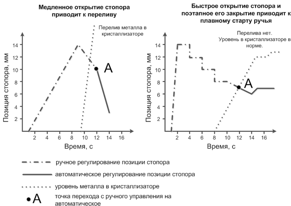
Рис. 5. Схемы открытия стопора и скорость набора уровня металла в кристаллизаторе
