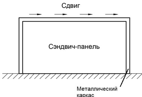
Рис. 1. Схема нагружения представительного элемента каркаса кузова с силовой обшивкой
