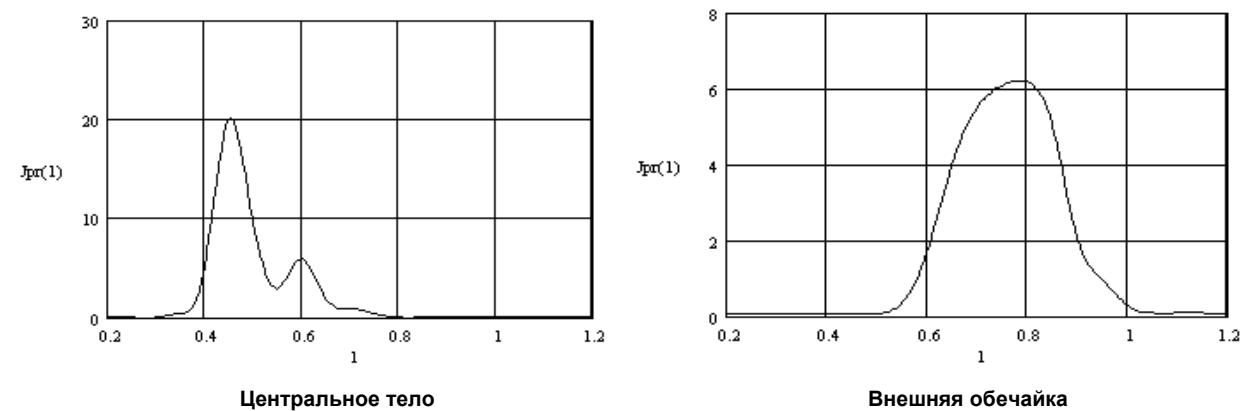
Рис. 3. Распределение импульса осаждения  $J_{pr}$  (%) по длине сопла
