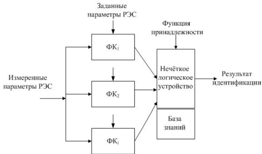
Рис. 1. Структурная схема устройства распознавания типов РЭС
