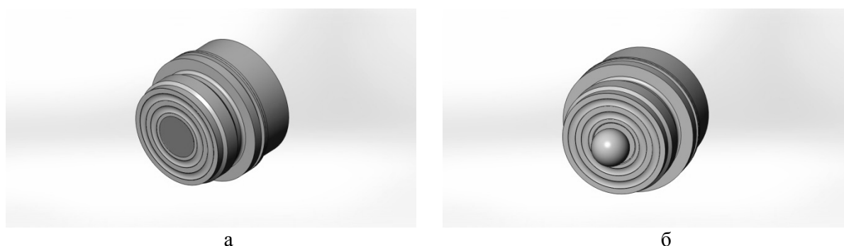
Рис. 3. Конструкция преобразователя с дополнительным слоем (а) и с дополнительным телом шарообразной формы (б) на разделительной мембране
