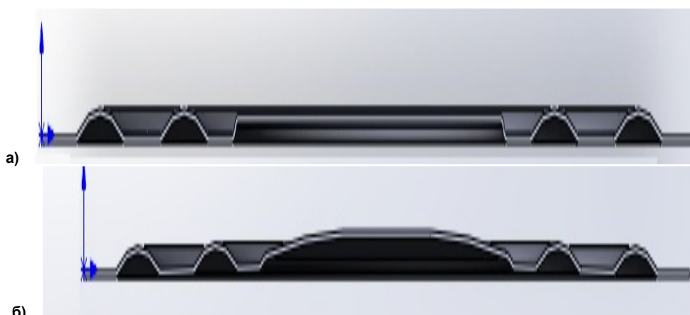
Рис. 4. Нормальная (а) и деформированная (б) разделительная мембрана
