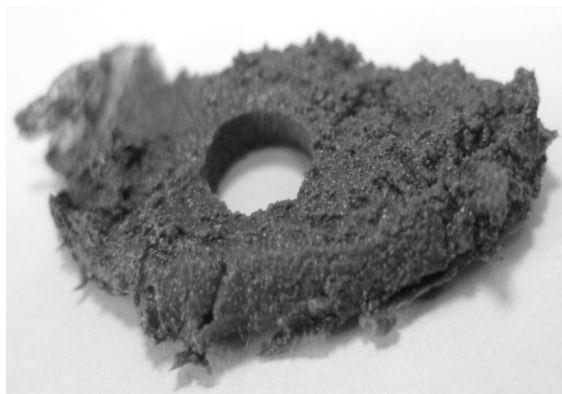
Рис. 2. Фотография полученной смеси порошков в самоотвердевающей жидкости
