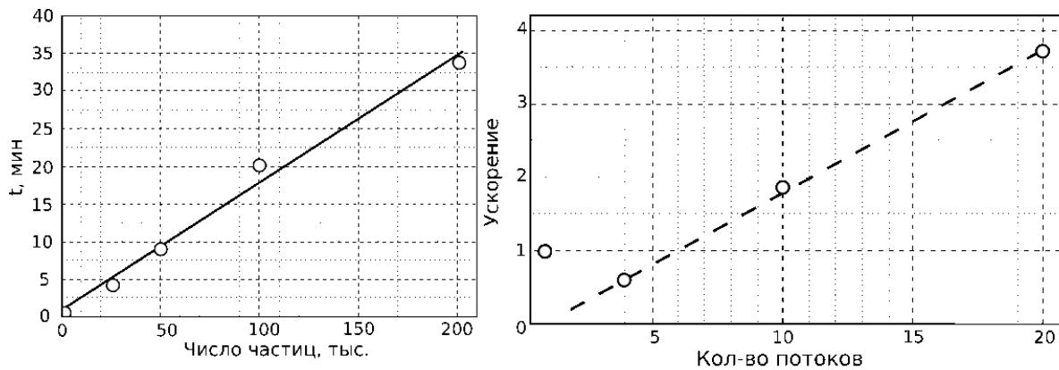
Рис. 7. Анализ производительности кода для расчета радиационных длин
