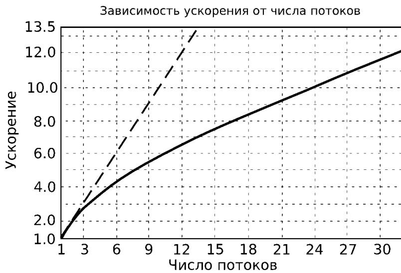
Рис. 6. Зависимость ускорения генерации событий в UrQMD от числа потоков при использовании многоядерной архитектуры PROOF
