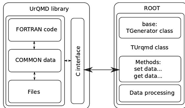
Рис. 2. Архитектура враппера для модели ядерных столкновений UrQMD
