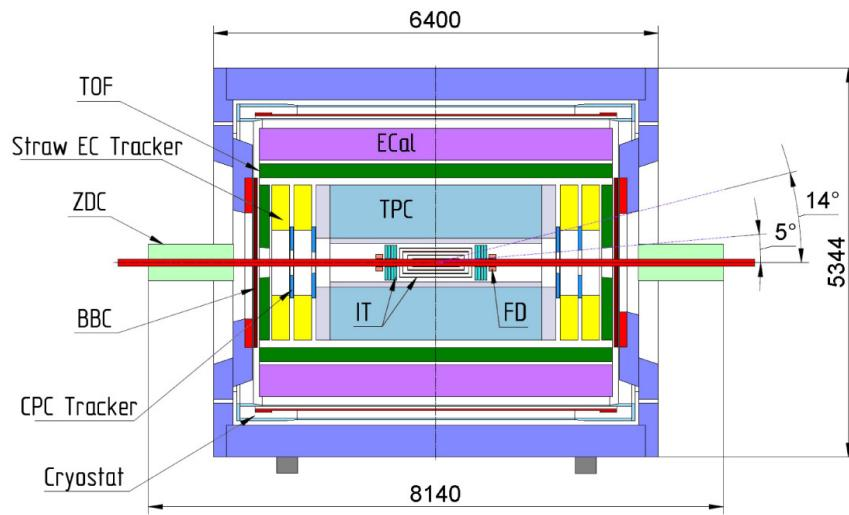
Рис. 1. Схема многоцелевого детектора MPD
