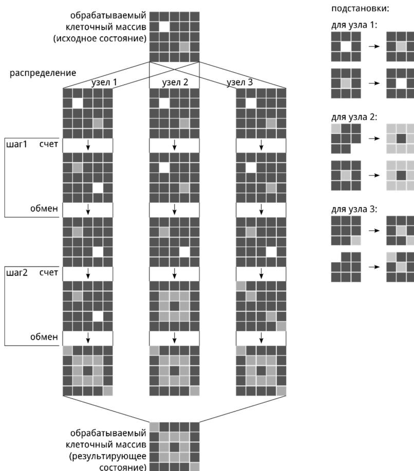
Рис. 5. Режим параллельного исполнения с разбиением множества подстановок
