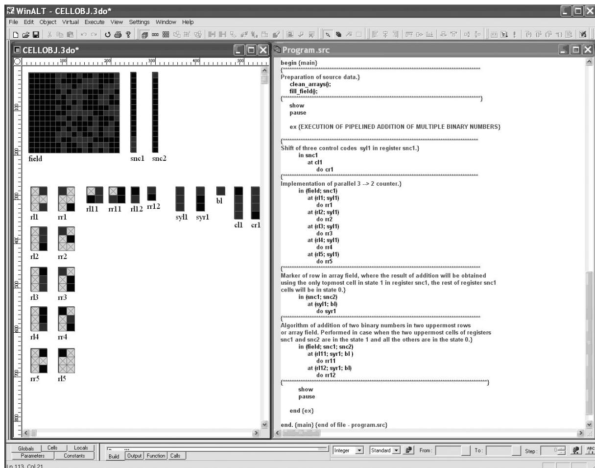
Рис. 1. Снимок экрана с примером модели сумматора многих чисел 3 в 2
