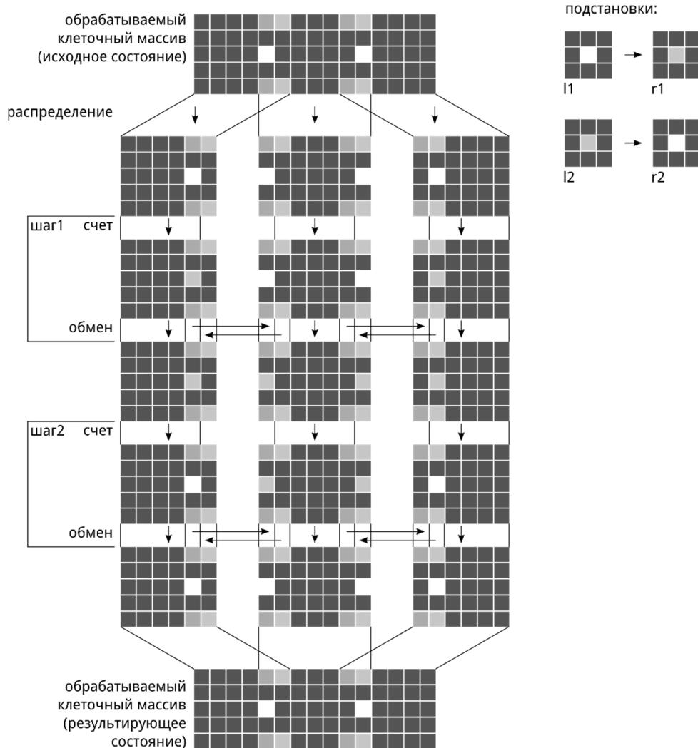
Рис. 4. Режим параллельного исполнения моделей с разрезанием объектов данных
