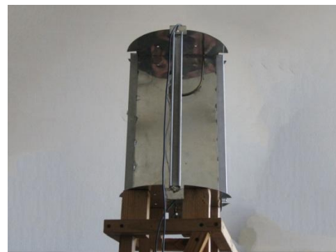
б) фотография макета турникетной антенны
