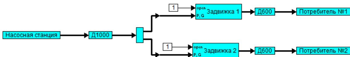
Рис. 2. Пример построения системы водоснабжения в среде VisSim
