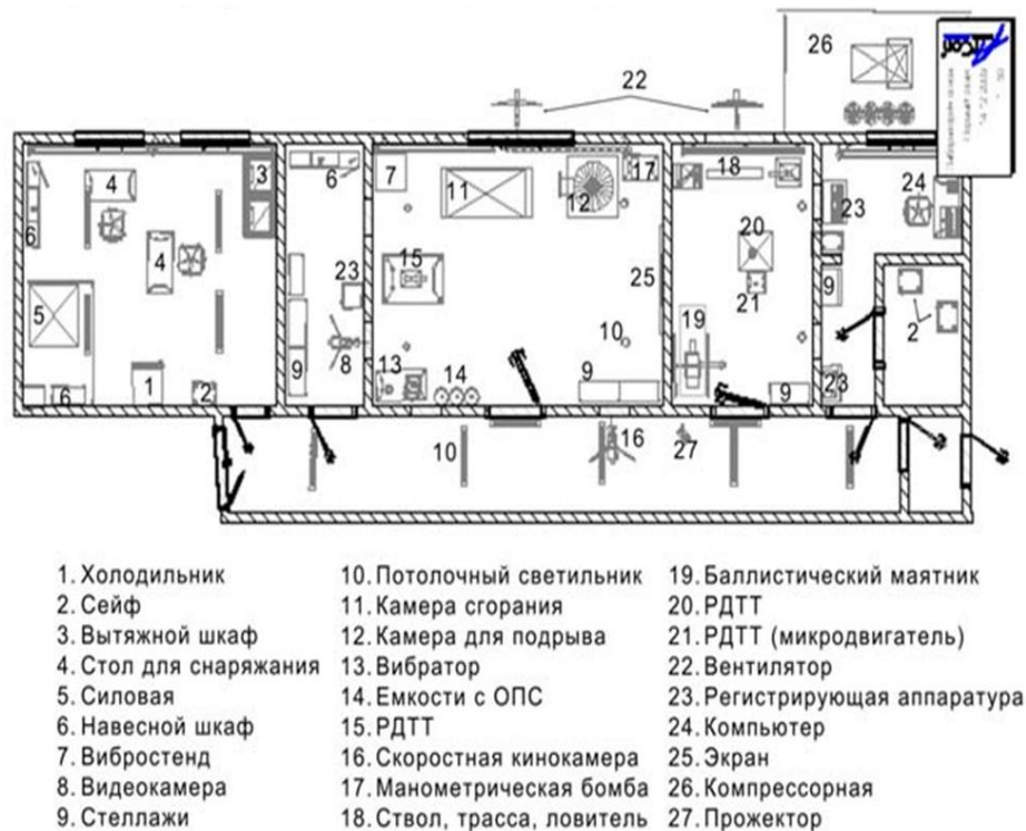
Рис. 4. План лаборатории огневых испытаний выстрелов и реактивной техники
