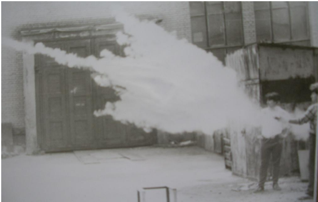
Рис. 2. Работа ручного огнетушителя с терочным приводом
