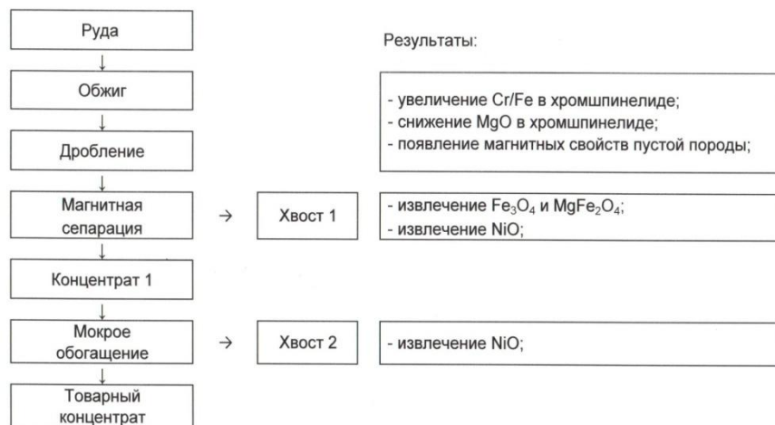
Рис. 6. Схема обогащения и извлечения сопутствующих элементов из хромовых руд массива Рай-Из с высоким содержанием никеля
