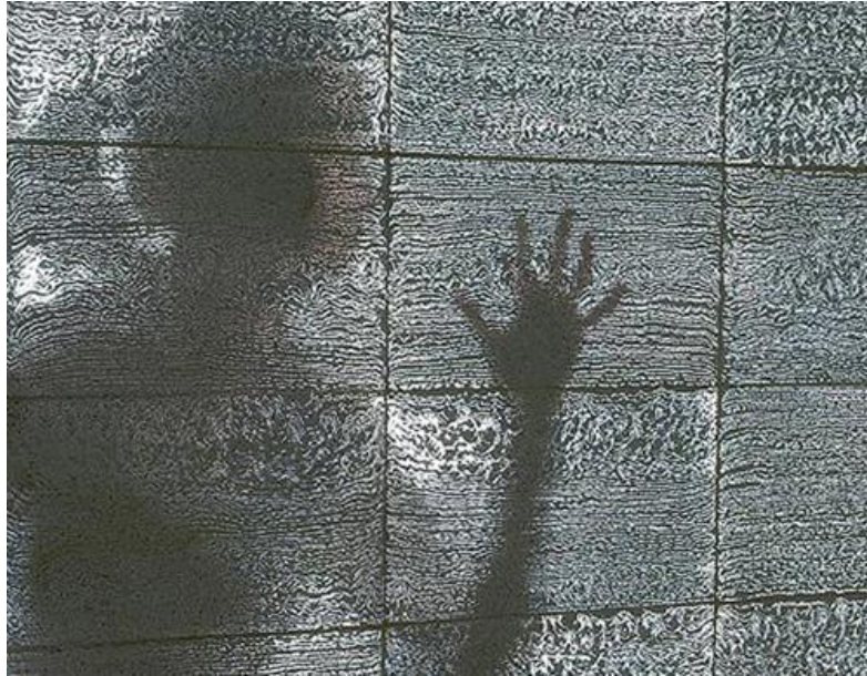
Рис. 1. Светопроводимость прозрачного бетона
