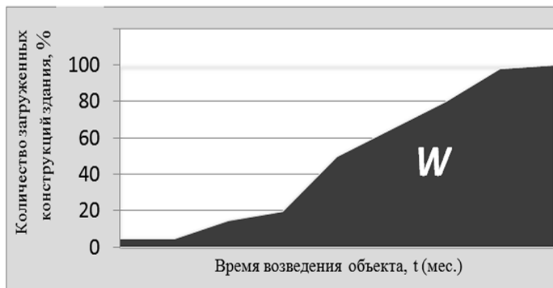
Рис. 2. Схема процесса возведения несущих конструкций объекта для определения w
