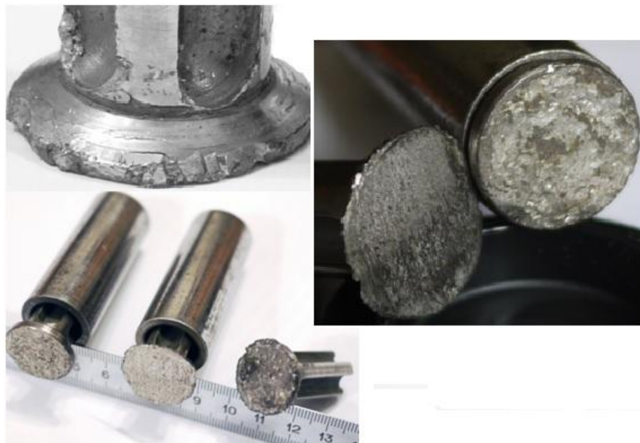
Рис. 3. Типичный характер износа клапанов и плунжеров
