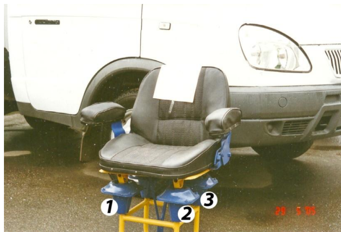
Рис. 1. Расположение акселерометров на металлической раме виброзащитного кресла
