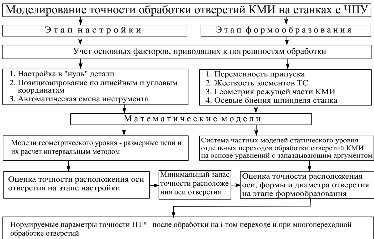
Рис. 1. Схема особенностей моделирования точности отверстий на станках с ЧПУ на этапах настройки и формообразования: КМИ – концевые мерные инструменты; ТС – технологическая система; ПТ – параметры точности
