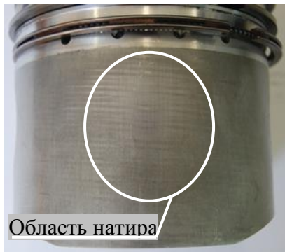
Рис. 1. Результат контактного взаимодействия юбки поршня и гильзы цилиндра дизеля ЧН13/15
