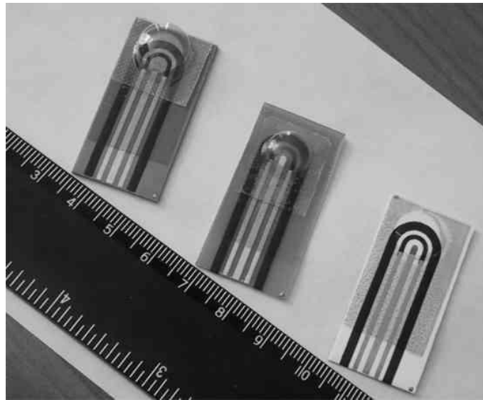
Рис. 2. Электрохимические ячейки, изготовленные на подложках из ситалла, стеклотекстолита и электрокерамики
