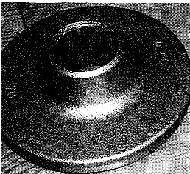
Рис. 8. Поковка фланца Р,16 D,50, изготовленная по открытой схеме ПРВК
