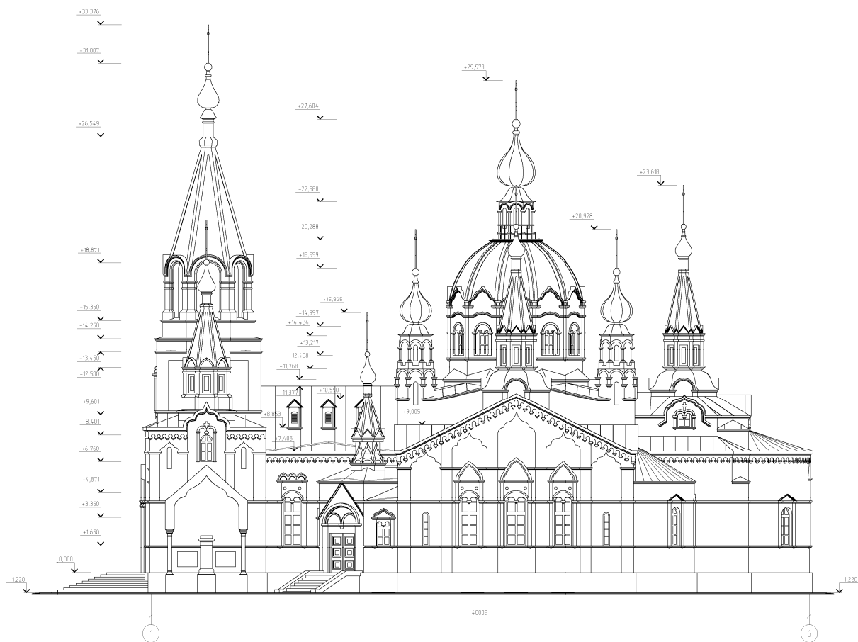
Рис. 3. Чертеж, автоматически полученный из CAD-модели
